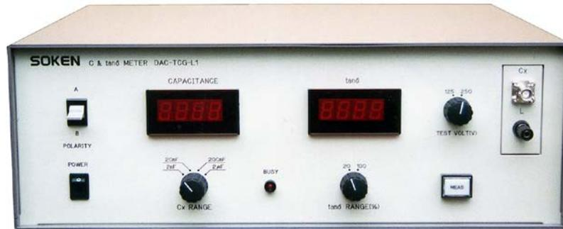
本装置は試験電源内蔵の  $\tan \delta$  測定器で、静電容量は広範囲に測定が可能であり、アナログ出力も備えておりますので、 $\tan \delta$  の経時変化などを測れる試験機であります。
