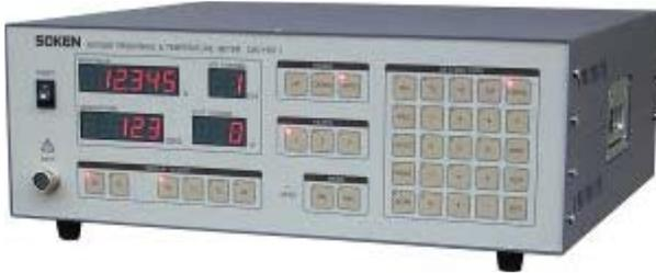
本機器はJIS5311に基づいた測定器で電気機器に交流電圧を加えた状態でコイルの抵抗測定値及び温度換算値を自動表示します。
