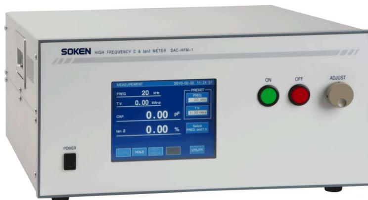
DAC-HFM-1は、絶縁材料の誘電率特性試験用に開発された測定器です。近年、絶縁材料に求められる耐電圧も高い傾向にあり、従来の低電圧での試験だけでは評価できない場合が考えられます。さらに、印加される周波数も商用周波数から高周波で使用されることが多く、絶縁材料の評価方法も高電圧、高周波の試験が必要となっております。DAC-HFM-1は、試験電圧最大250V、試験周波数1kHz～50kHzまでと広範囲に測定できますので、従来困難であった高電圧、高周波の特性試験が可能となり、絶縁材料の研究開発におきまして安全性、信頼性を測る上で最適な測定器となります。
