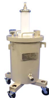
標準コンデンサ 100pF/40kV
